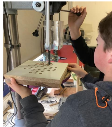
Perçage des trous du solitaire et du jeu du moulin avec gabarit (élèves)
