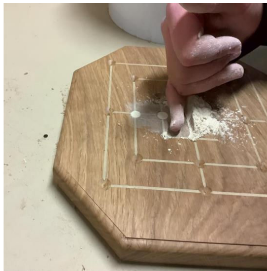
Remplissage des rainures du jeu du moulin avec plâtre à bois puis ponçage (élèves)
